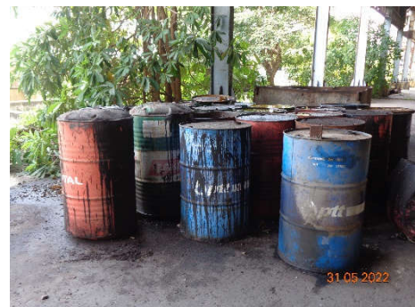
ภาพที่ 2.2-16 การจัดเก็บน้ำมันจากระบบปรับปรุงคุณภาพน้ำหมุนเวียน/ถังเหล็กปนเปื้อนน้ำมัน
